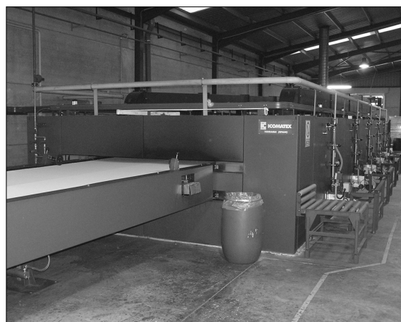
Una de las últimas inversiones de la empresa, un horno de gran capacidad preparado para realizar múltiples acabados en los tejidos.
